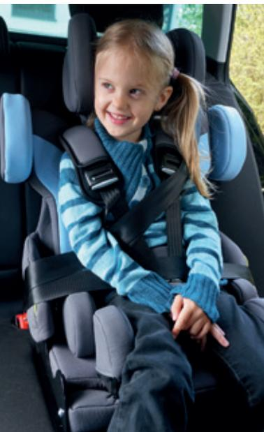
Reha-Autositze verfügen über eine spezielle Reha-Ausstattung und eine Auswahl an Reha-Zubehör, durch die der Sitz besser an die besonderen Bedürfnisse des Kindes angepasst werden kann.
